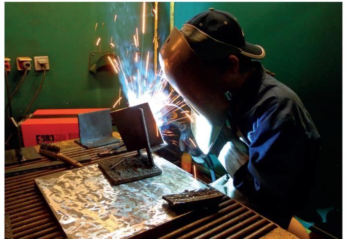
Schutzgasschweißen, BW Mold
