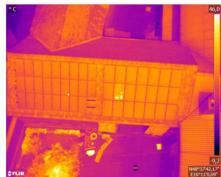
Durch eine fehlerhafte Zelle kann die Gesamtleistung der PV Anlage drastisch sinken © LK NÖ
