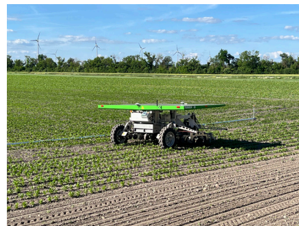
Feldroboter übernimmt die Aussaat und in Folge die Hackdurchgänge am Standort Obersiebenbrunn © Erhard Kührer
